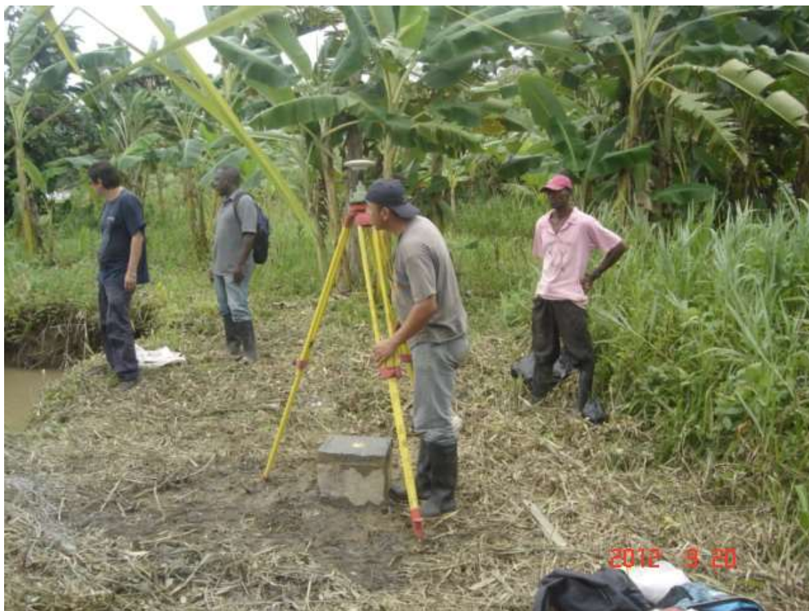
Foto. Georeferenciación del Punto de Referencia (BM) del sitio denominado “Casimiro, Quibdó”.
