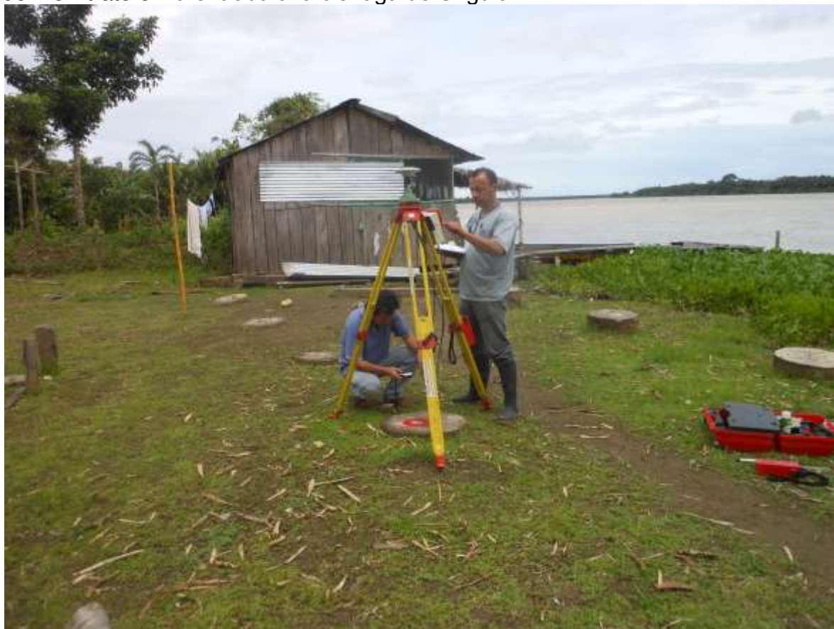
Foto. Georeferenciación del Punto de Referencia (BM) en la margen izquierda del río Atrato en la entrada a la ciénaga de Unguá”.
