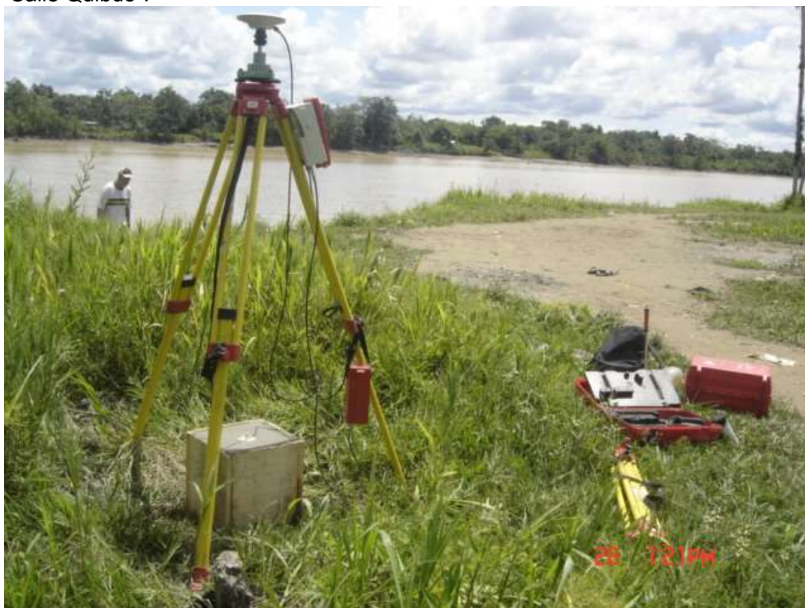
Foto. Georeferenciación del Punto de Referencia (BM) del sitio denominado “Calle Quibdó”.
