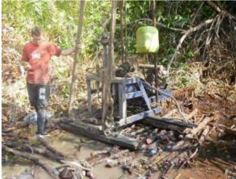
Fotografía 12 . Exploración del subsuelo en el sitio para el futuro puerto marítimo del golfo de Urabá - "Tarena".
