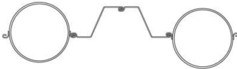
Ilustración 32. Sección transversal de muro de contención combinado, pilotes y tablestaca metálica.
