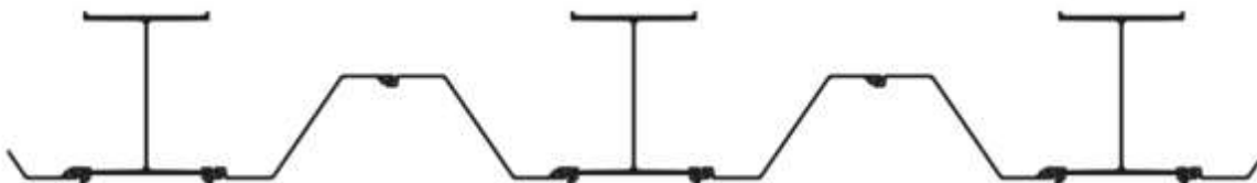
Ilustración 33. Sección transversal de muro de contención combinado, perfiles en H y tablestaca metálica.
